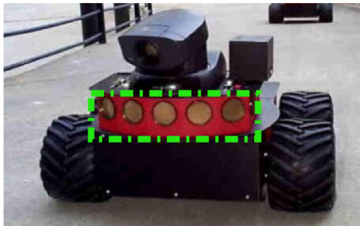
Figura 1.2: Distribuci3n de s3nars (delimitada en color verde) en robot m3vil
