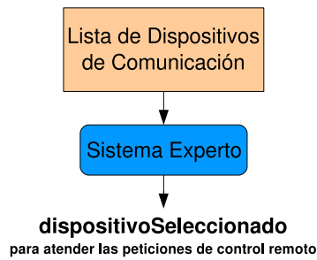
Figura 15.26: Sistema Experto para seleccionar el dispositivo de comunicación más apropiado para escuchar las peticiones de Control Remoto
