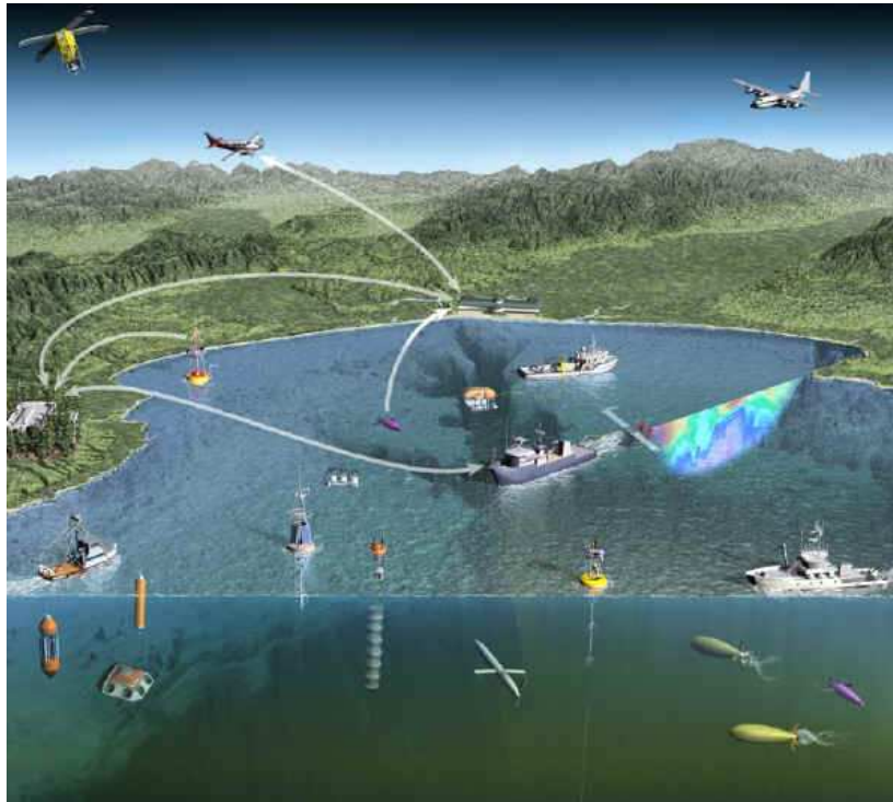
Figura 2.2: Coordinación de múltiples vehículos o sistemas de exploración oceanográfica. Autonomous Ocean Sampling Network (AOSN)
