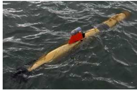
(c) Vehículo de crucero, con diseño en forma de torpedo. AUV Gavia
