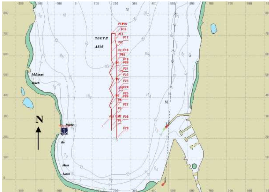
Figura 11.2: Ejemplo de especificación gráfica de seguimiento de ruta —compuesta de waypoints — con el software de [Issac et al., 2005]
